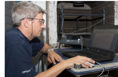
Temperaturverteilungsmessung an einer Wärmebehandlungsanlage.
