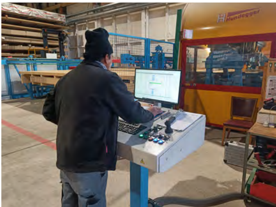
Unser Mitarbeiter Uditha schneidet die OSB-Platten an der CNC-Maschine zu
