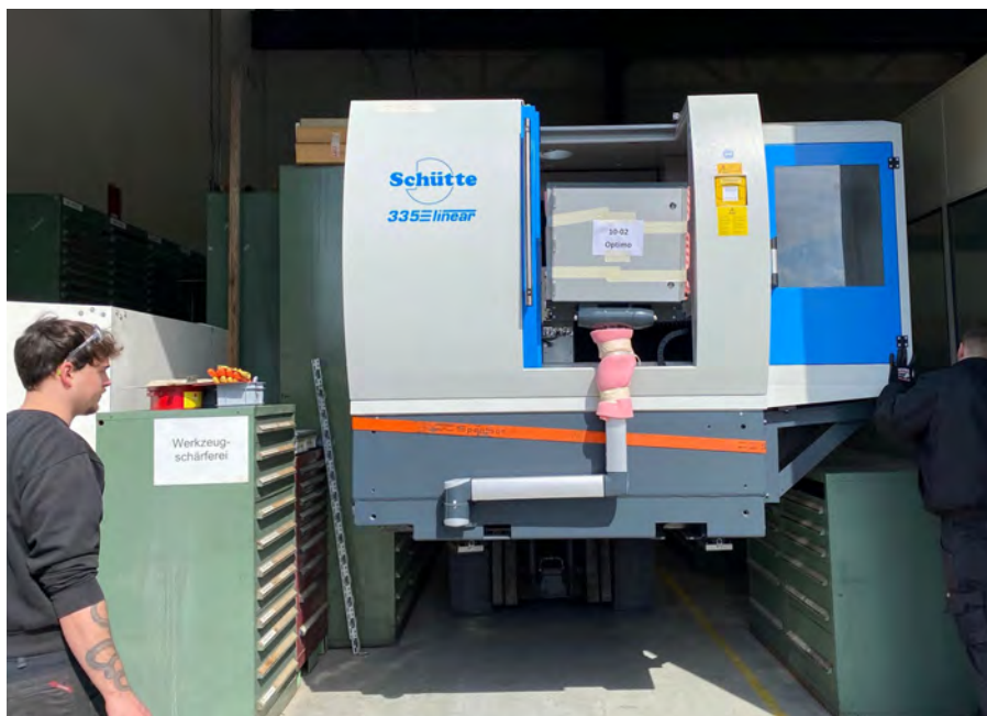
Anlieferung der neuen CNC-Schleifmaschine in die Werkstatt der Schärfttechnik.
