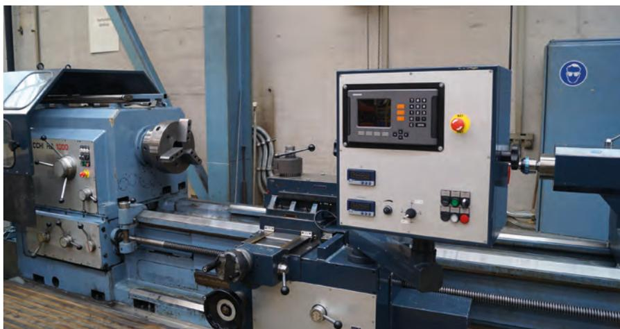
Zudem wurden sämtliche Steckrelais ersetzt und der Hauptspindelmotor, von unserem Partner für Motoren, komplett revidiert. Der Service bestätigte den guten, mechanischen Zustand der Drehmaschine.
