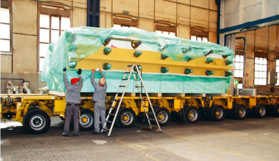
Bei einer Seeverpackung gehört dem Korrosionsschutz blanker Maschinenteile besondere Aufmerksamkeit.
