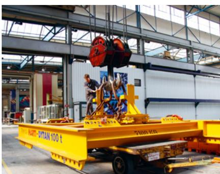
Schon am Nachmittag wird die Hebevorrichtung bereitgemacht. Sie wiegt allein 7,1 Tonnen!
