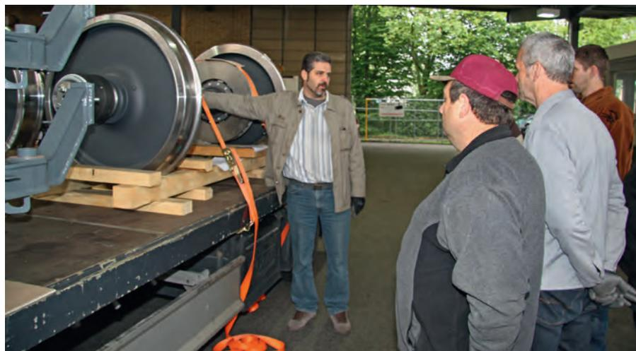
Thomas Miani, Leiter Transporte, zeigt einigen Fahrern die Sicherung einer Eisenbahn-Radachse.
