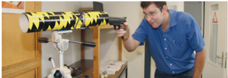
*Ob das Projektil aus der Luftpistole die Schutzbrille durchschlägt?*
