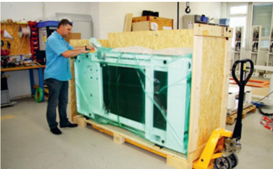
Und so wird das Gerät auf die Reise gebracht. In nur zwei Kisten sind alle Komponenten, inklusive der Kleinteile, in VCI-Folie oder Luftpolster-Folie sowie Kartons nach einem durchdachten Plan platziert.
