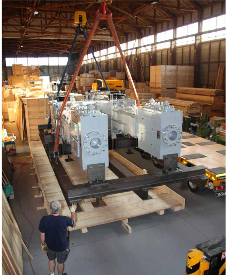
Von zwei Kranführern behutsam gesteuert, schwebt das 41 Tonnen schwere Triebwerk in Richtung Kistenboden.
