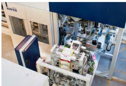
... zur Abfüllanlage (hier im Bild). Die Anlage hat mehrere rotierende Füllstutzen, wobei jeder Füllstutzen einen Sack abfüllt. Nach der Abfüllung wird das Produkt zugeschweisst und auf der Kontrollwaage nach seinem Gewicht geprüft. Ist dieses zu tief, wird der Sack aussortiert ...
