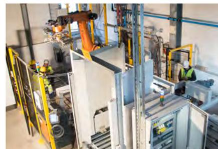
... und die Abfüllmenge des betreffenden Abfüllstutzens angepasst. Im letzten Teil der Abfüllanlage werden die Säcke durch einen Roboter palettisiert. Die vollen Paletten werden dann zu einem Zwischenlager befördert.
