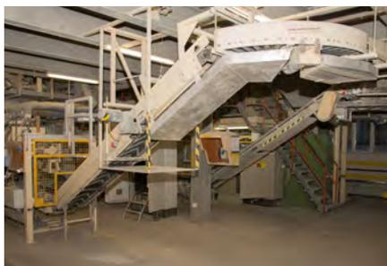
Die alte Abfüllanlage arbeitete mit zwei Abfüllstrassen und erbrachte eine Verpackungsleistung von ca. 750 Säcken pro Stunde. Die neue Anlage bringt es auf bis zu deren 1'000 und ist vollautomatisiert. Nach der Sackerstellung und Etikettierung gelangen die Säcke ...
