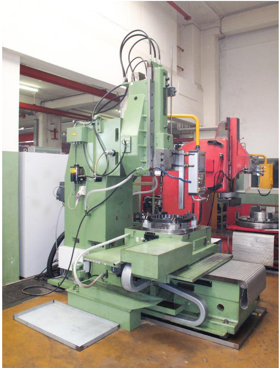
Dank einer Komplettanierung wurde die Stossmaschine SE-500 aus dem Jahr 1988 für die nächsten 15-20 Jahre wieder fit gemacht.
