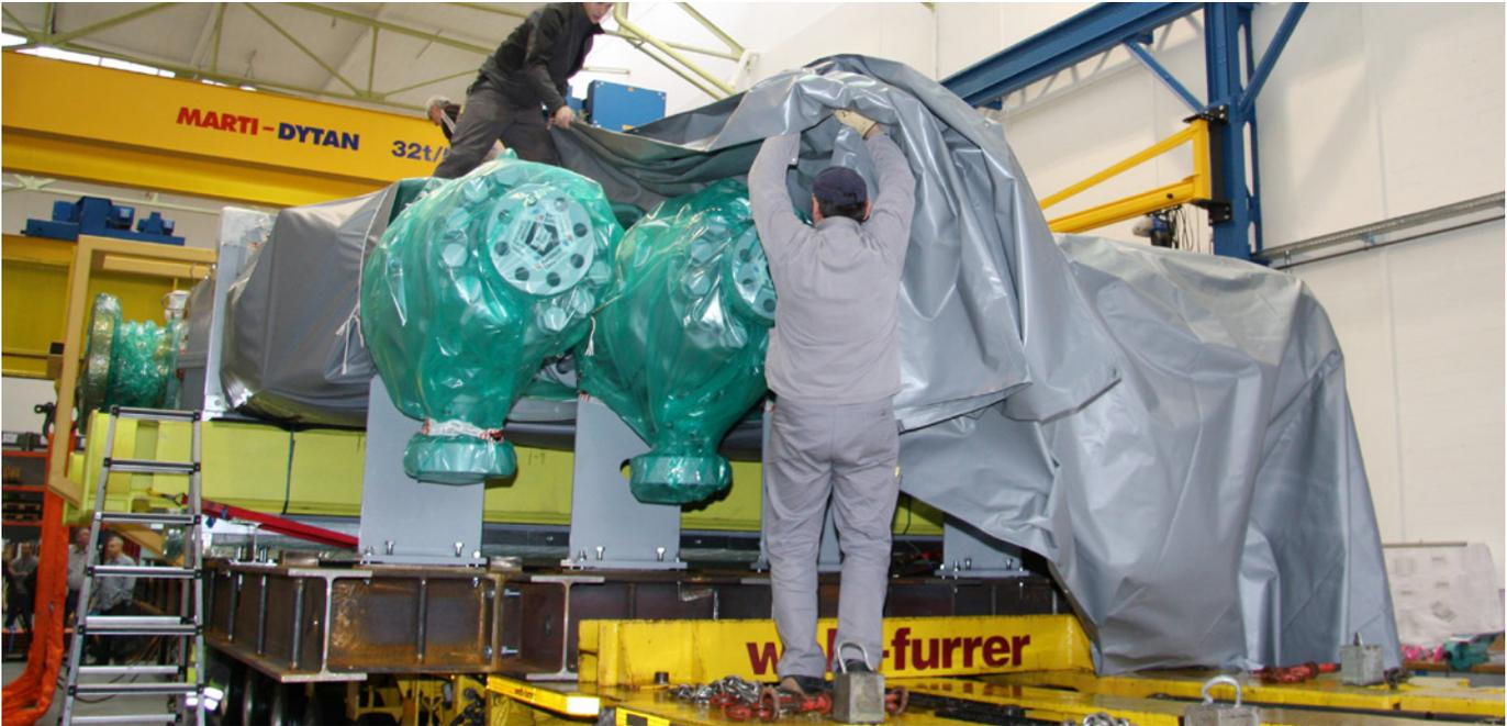
Zum Schutz vor Regen und Spritzwasser wird der Kompressor mit einer riesigen Plane abgedeckt.
