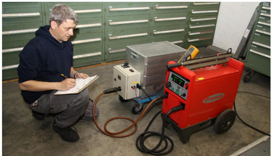
Messtechniker Marcel Hiltbrand beim Kalibrieren einer Schweissmaschine. In Bildmitte steht die mobile Belastungseinheit.
