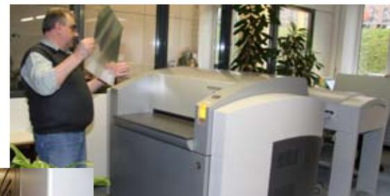
Alex Meyer, Offset-Drucker bei Optimo Service, kontrolliert eine belichtete Platte und setzt sie ins entsprechende Farbwerk ein.
