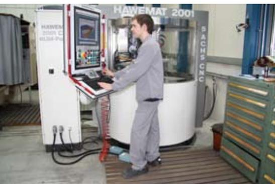
*Neu in unserer Werkzeugschärferei: Die «Hawemat 2001», eine 5-Achs CNC-Schleifmaschine modernster Bauart.*
