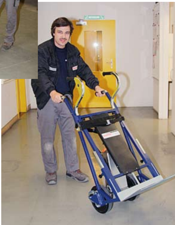
Diese Bildleiste erläutert die Funktion. Der Treppensteiger arbeitet mit zwei unterschiedlichen Radgrössen und einem Blockierungssystem: Das kleine Rad stützt sich auf der vorausgehenden Treppenstufe ab und zieht dann über einen Drehmechanismus das grosse Rad nach: Raffiniert – und einfach...
