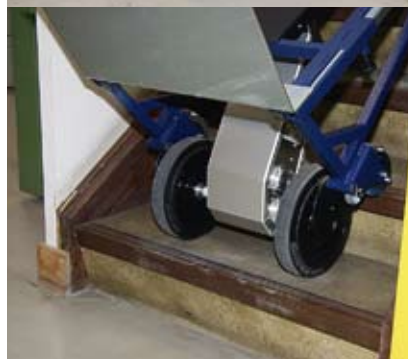
Diese Bildleiste erläutert die Funktion. Der Treppensteiger arbeitet mit zwei unterschiedlichen Radgrössen und einem Blockierungssystem: Das kleine Rad stützt sich auf der vorausgehenden Treppenstufe ab und zieht dann über einen Drehmechanismus das grosse Rad nach: Raffiniert – und einfach...
