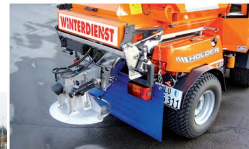
Pfaden und Salzen geht beim neuen Fahrzeug gleich in einem Arbeitsgang.
