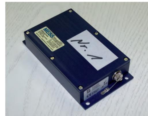
Dem gerade mal 145 mm langen Gerät entgeht auf der Reise von empfindlichen Gütern keine Erschütterung.
