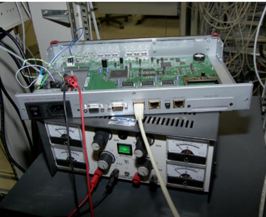
*Vom Netzgerät (unten) führt eine Klemmverbindung ins Innere der defekten Box.*
